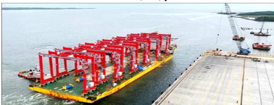
Imagen No. 4 1 Grúa (STS) y 11 Grúas RTG
