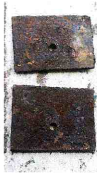
Estado de orejas metálicas
